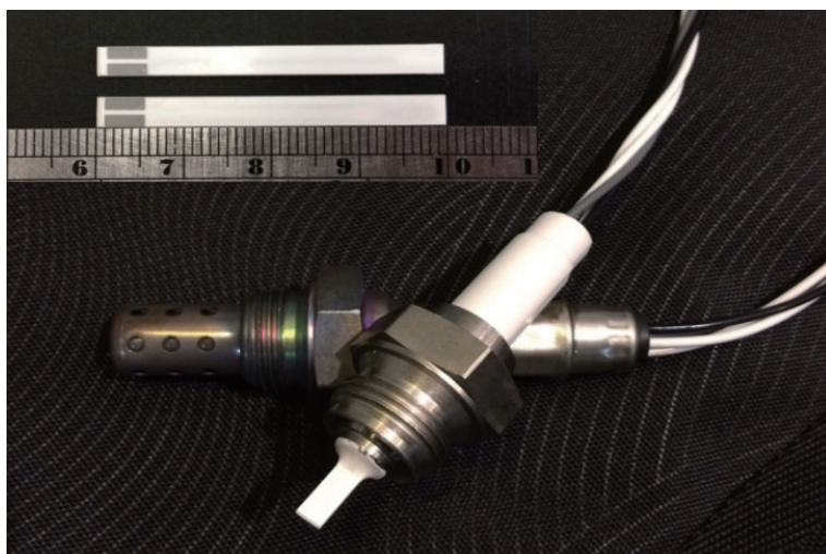
圖 5. 本研究封裝後之平板式 \text{NO}_x 感測器實體照片。
