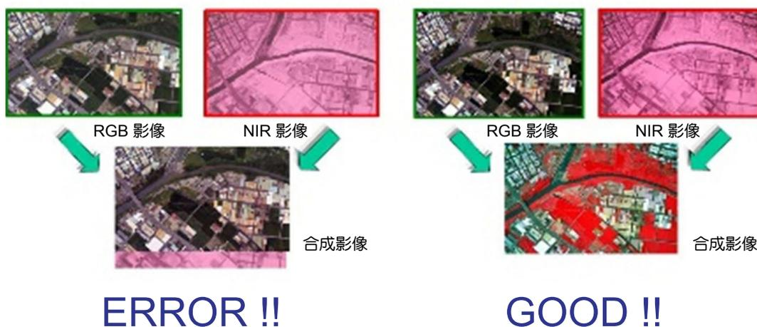
圖 2. 雙影像模組不同步會造成影像套合困擾示意圖。
