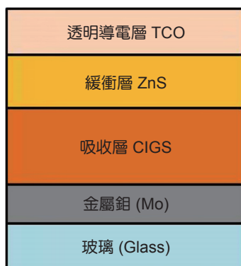
圖 1. CIGS 薄膜太陽能電池的結構示意。
