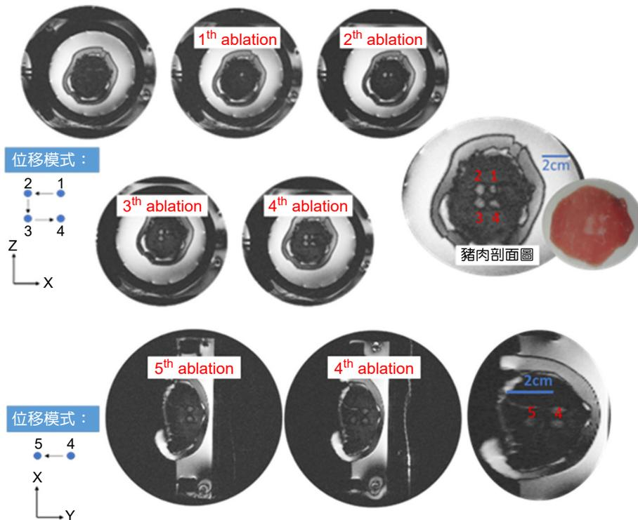
圖 11. 自動定位機構帶動換能器消融仿體的 IR 圖。白色為熱消融產生的焦斑。
