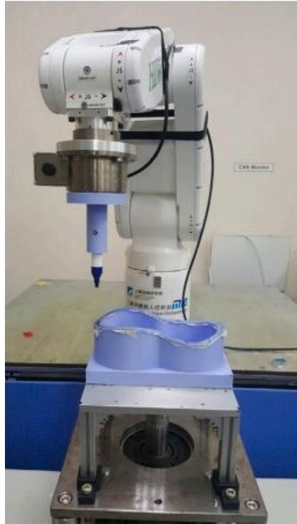
圖 6. 3D 模型輪廓追蹤實驗設置。
